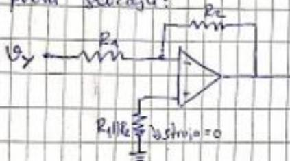
$$v_p' = -\frac{R_2}{R_1} v_y \quad (\text{invertirajući pojačavač})$$
