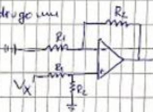
$$v_p'' = v_x \frac{R_2}{R_1 + R_2} \cdot \left(1 + \frac{R_2}{R_1}\right) \quad (\text{neinvertirajući pojačavač})$$
