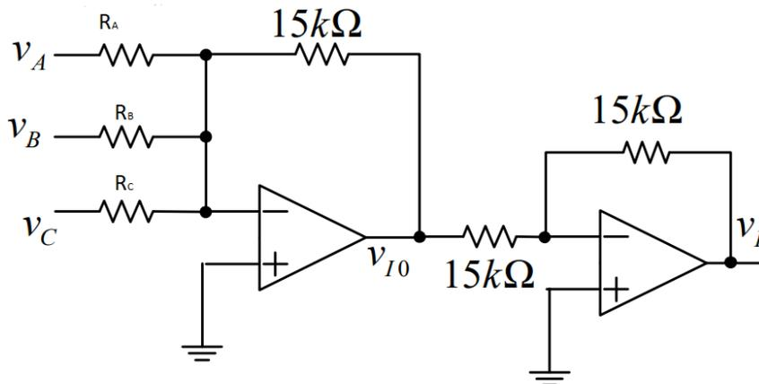
$$V_i = V_A + 3V_B + 5V_C \Rightarrow V_{I0} = -V_A - 3V_B - 5V_C$$
